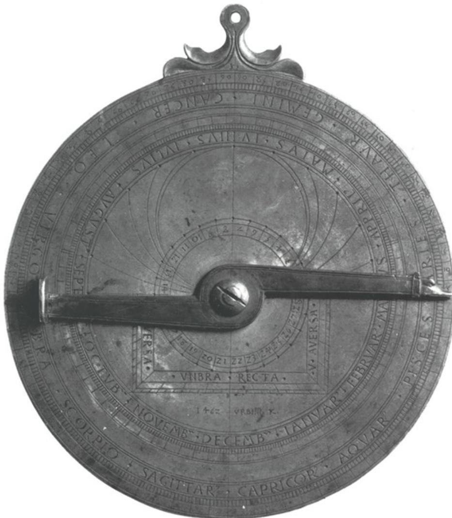
Die Formen der Ziffern auf der Rückseite weichen von jenen des Vorderseiten-Limbus ab, zudem sind einige der für Zahlen vorgesehenen Felder der Rückseite leer geblieben. Es scheint, dass das Instrument nicht in einem Zug entstanden ist, sondern zu zwei oder sogar drei (Grobbeschriftung der Einlegescheiben) verschiedenen Zeiten und vielleicht an unterschiedlichen Orten daran gearbeitet wurde.
