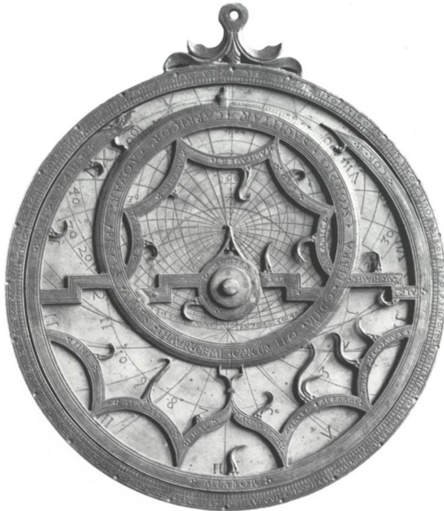
Eine Besonderheit stellt die Dämmerungslinie dar, die nicht wie gewohnt  $18^\circ$  unter dem Horizont liegt (astronomische Dämmerung), sondern so konstruiert ist, dass sie den Schnittpunkt der 1. bzw. 11. Ungleichen Stunde mit dem Äquator trifft. Damit passt die Dämmerungslinie ungefähr zur nautischen Dämmerung, wenn die Sonne  $12^\circ$  unter dem Horizont steht:
